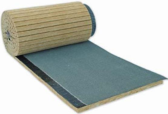
**ChovATERM®** es un complejo formado por un aislamiento térmico, con lamas cortadas de paneles de LR – **LAROC**, adheridas térmicamente a láminas bituminosas de betún modificado con elastómeros - **POLITABER**.
